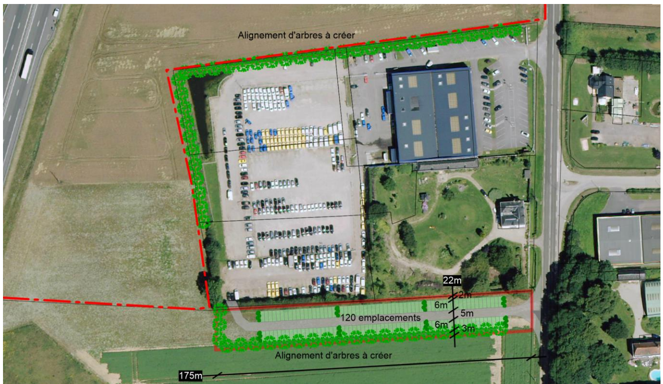
Figure 106 : Exemple d'aménagement de 120 emplacements de stationnement
